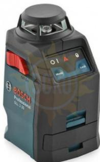
Лазерный нивелир Bosch GLL 2-20 Kit проецирует круговую замкнутую горизонтальную плоскость на удалении до 20 м. Расстояние от верхней точки корпуса до горизонтальной лазерной плоскости у него составляет всего 4 мм, благодаря чему этот построитель пользуется особой популярностью среди монтажников потолочных конструкций, обеспечивая задание опорной линии максимально близко к плитам перекрытия — это позволяет выполнять крепёжные работы без промежуточных промеров.
