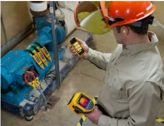
Рис. 2. Прием и сохранение в приложении Fluke Connect на смартфоне результатов измерений с приборов, подключенных к беспроводной сети
