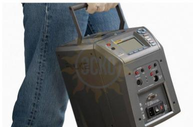
Сухоблочный калибратор температуры **Fluke 9144-F-P-256** - это надежное решение для оперативного тестирования и настройки измерителей температуры в диапазоне от 50 °C до 660 °C, которое отлично подходит для работы в полевых условиях с лабораторной точностью.
