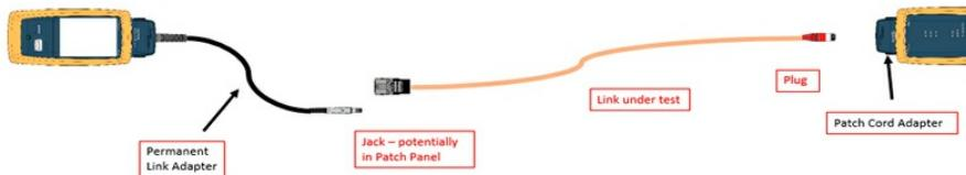
Адаптер коммутационных шнуров поддерживает уровни производительности категорий 5е, 6 и 6A и работает со всеми моделями анализаторов DSX CableAnalyzer™. Для использования тестировочных допусков MPTL необходима последняя версия микропрограммного обеспечения Versiv/DSX.
