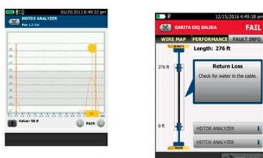
Высокоточный анализ перекрестных наводок (HTDTx) демонстрирует, что проблема заключается в соединении на дальнем конце
