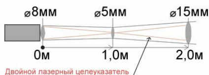
Рис. 1. Показатель визирования датчика: 1:200
