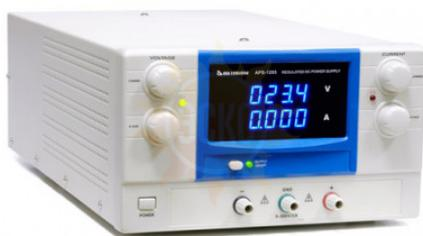
Источник питания APS-1205 схемотехнически выполнен по линейной схеме стабилизации и предназначен для выдачи плавно регулируемого стабилизированного напряжения от 0 до 200 В и тока 5 А. При этом заявленные выходные параметры доступны во всем диапазоне токов и напряжений и таким образом максимальная выходная мощность APS-1205 составляет 1000 Вт.
