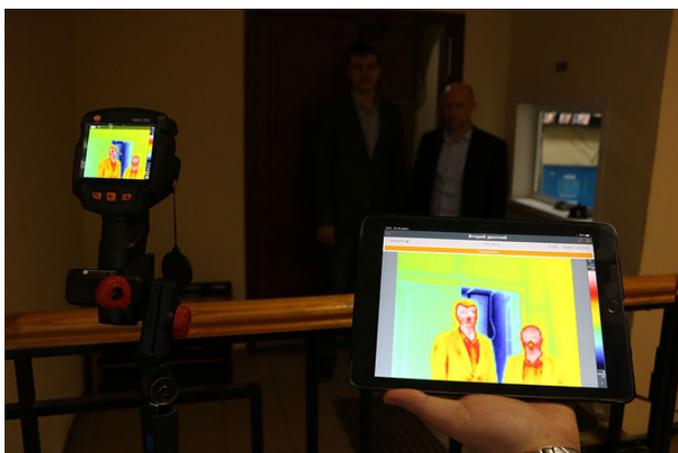
Рис. 1. Термограммы, которые можно получить с помощью тепловизионного комплекса **ТермоВед 422 МЕ Контроль**
