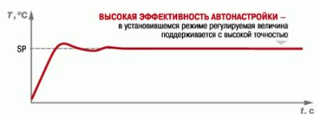
При автонастройке прибор вычисляет оптимальные для данного объекта значения коэффициентов ПИД-регулирования. Последующая несложная ручная подстройка позволяет свести к минимуму перерегулирование.
