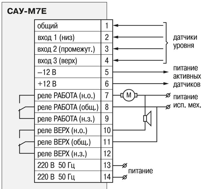
СХЕМА ПОДКЛЮЧЕНИЯ ДАТЧИКОВ УРОВНЯ
