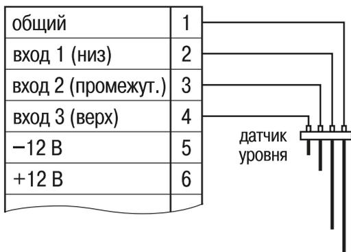
Схема подключения кондуктометрических датчиков уровня
