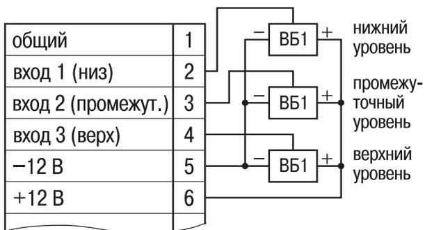
Схема подключения емкостных переключателей
