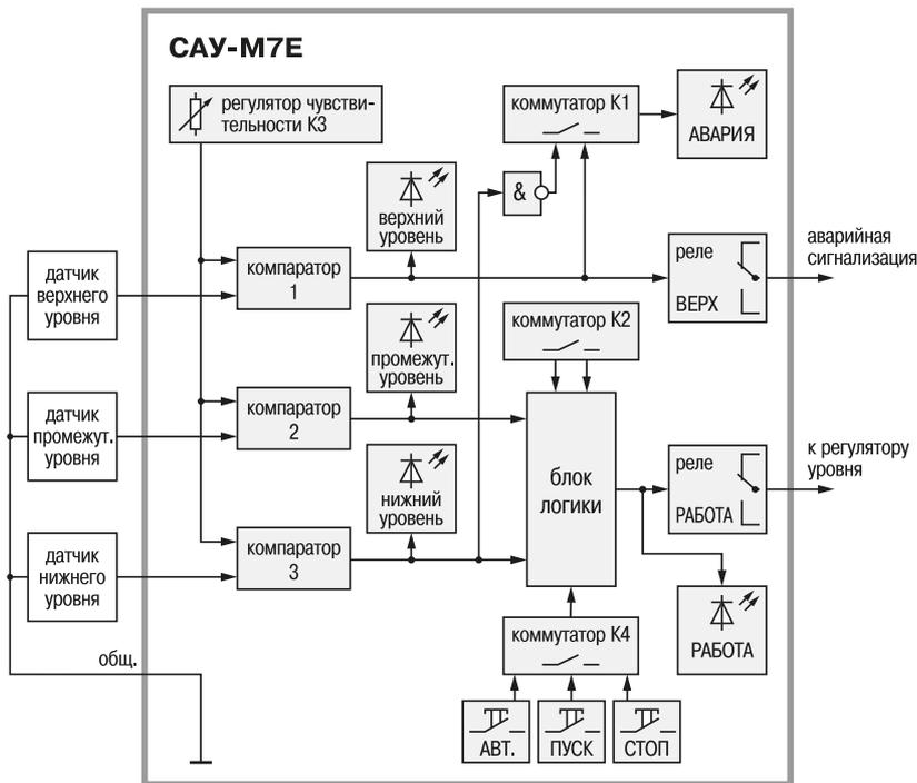
Контроль уровня осуществляется при помощи трех датчиков, которые устанавливаются пользователем в резервуаре на заданных по условиям технологического процесса отметках: **нижней, промежуточной, верхней.**
