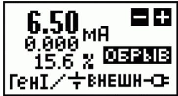
Экран прибора в режиме генерации тока с плавным изменением задания
