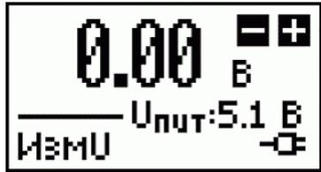
Экран прибора в режиме измерения напряжения
