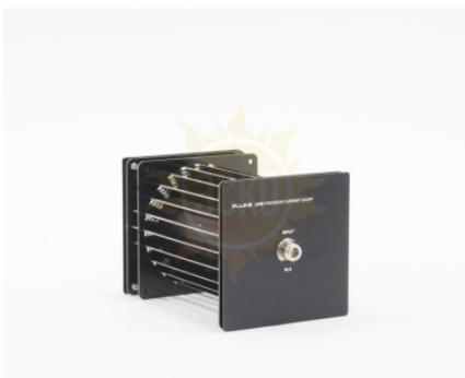
Широкий диапазон номиналов шунтов **серии Fluke A40B** позволяет проводить измерения тока от 0,1 мА до 100 А. Конструкция и компоненты токовых шунтов обеспечивают высокую плоскостность амплитудно-частотной характеристики (ошибка смещения амплитуды относительно сопротивления постоянного тока). Кроме этого, смещение фазы при 100 кГц достаточно мало, чтобы им можно было полностью пренебречь во всех измерениях, кроме особо точных.
