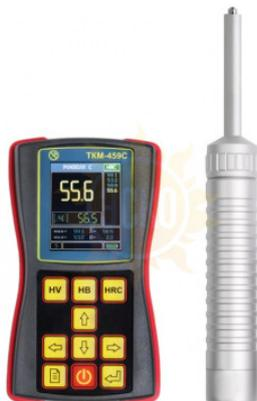
Наконечник длиной 65 мм позволяет выполнить измерения твердости в самых труднодоступных местах:
