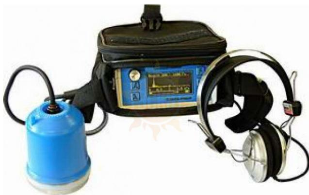
**АКУСТИК** - прибор для поиска утечек в трубопроводах хозяйственно-питьевого водоснабжения. Прибор применим так же и для других систем трубопроводов, при условии, что транспортируемая среда выходит из трубы под давлением и возникающий звук распространяется до поверхности земли.
