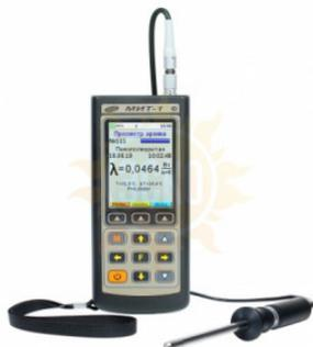
Измерители теплопроводности **МИТ-1** предназначены для оперативного определения теплопроводности строительных и теплоизоляционных материалов (твёрдых, волокнистых, сыпучих) зондовым методом по ГОСТ 30256.
