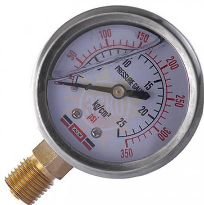
Маслозаполненный манометр **МЕГЕОН 98120М** предназначен для замены неисправного или повреждённого манометра на опрессовочном насосе МЕГЕОН 98120, а также на другом технологическом оборудовании сторонних производителей. Корпус изготовлен из стали и имеет нижнее крепление. Предельно измеряемое давление составляет 2,5 МПа. Присоединительный размер резьбы М14х1,5.
