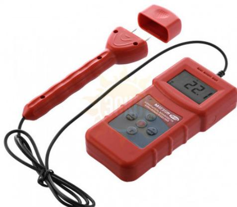
Измеритель влажности бумажных изделий **МЕГЕОН 20720** используется для измерения влажности картона, бумаги, втулок из бумаги и картона и других материалов, сделанных из бумаги. Прибор применяется для обработки дерева, бумаги, мебели, зданий и сооружений, лесозаготовителей и других соответствующих отраслей промышленности.
