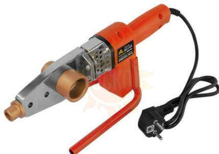
МЕГЕОН 98100, это ручной сварочный аппарат для полимерных труб предназначен для сварки полидифузионным методом труб и соединительных деталей из термопластов. Аппарат для сварки полимерных труб - это электрический нагревательный прибор, предназначенный для контактной сварки труб из полимерных материалов через муфтовое соединение нагревательным элементом. Аппарат для сварки пластиковых труб имеет встроенный терморегулятор, который позволяет автоматически поддерживать заданную температуру.
