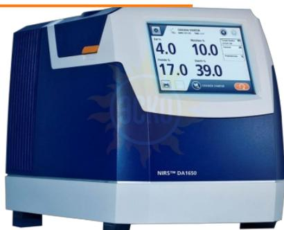
Возьмите под контроль процесс измельчения масличных культур с помощью надежных измерений для цельных семян масличных культур, жмыха и шротов. Точный и надежный анализ масличных культур для использования в лаборатории или на производстве для получения важных данных на разных этапах процесса.
