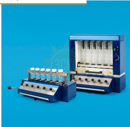
FT 122 Fibertec™ — это система ручного определения волокон, предназначенная для простого определения сырой клетчатки, моющих волокон и т. д. в соответствии со стандартными эталонными тигельными методами, такими как Weende, van Soest и т. д.
