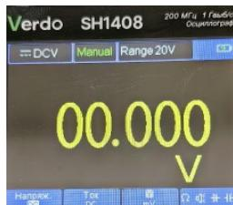
Осциллографы VERDO SH1400 имеют встроенный 1-канальный мультиметр, метрологические параметры которого внесены в описание типа прибора. Диапазон отображаемых измерений – 4 ½ разряда (20 000 отсчетов). Базовая погрешность прибора 0,3%, измеряемые величины: напряжение и ток постоянного и переменного тока, сопротивление, емкость, также встроенные функции тестирования диодов и прозвонки цепи.
