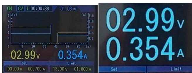
Экран прибора позволяет одновременно отображать установленные и измеренные значения напряжения, тока, а также позволяет выводить на экран потребляемую мощность подключенной нагрузки. Указанная функция может быть весьма полезна при разработке электронных устройств, а также при их диагностике и ремонте.
