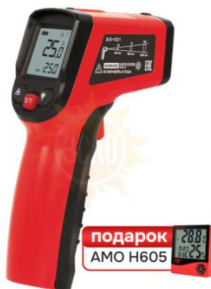
Пирометр RGK PL-7 Max - модификация популярной модели инфракрасного термометра PL-7. Главное отличие этой модели от базовой - расширенный рабочий диапазон, который составляет от -30 до +500 °С. Это позволяет контролировать самые разные технологические процессы, от заморозки до высокотемпературных операций. При этом точность осталась на том же высоком уровне, поскольку погрешность данных в большей части диапазона не превышает 2°С.
