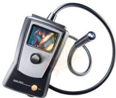
Профессиональный **видеоэндоскоп Testo 318-V3** с видеовыходом для визуальной диагностики рекомендован для инспекции скрытых и труднодоступных мест. Сенсор расположен на конце трубки, диаметр которой составляет 10,6 мм, передает видеоизображение высокой четкости на цветной ЖК дисплей диагональю 2,5". Благодаря сверхчувствительной оптике с автоматической фокусировкой и яркой светодиодной подсветке дисплея вы можете рассмотреть объекты на расстоянии всего 9 см.
