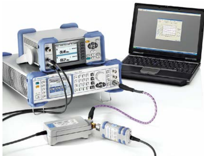
Измерительная установка для калибровки преобразователя мощности NRP-Z55
