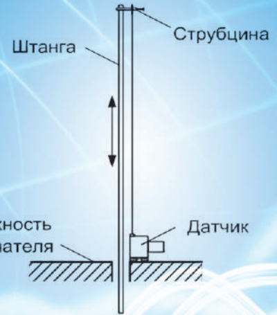
Схема установки датчика перемещения на МКП-110
