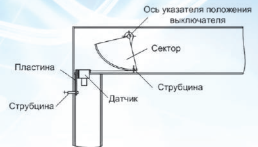
Схема установки датчика перемещения на BMT-110
