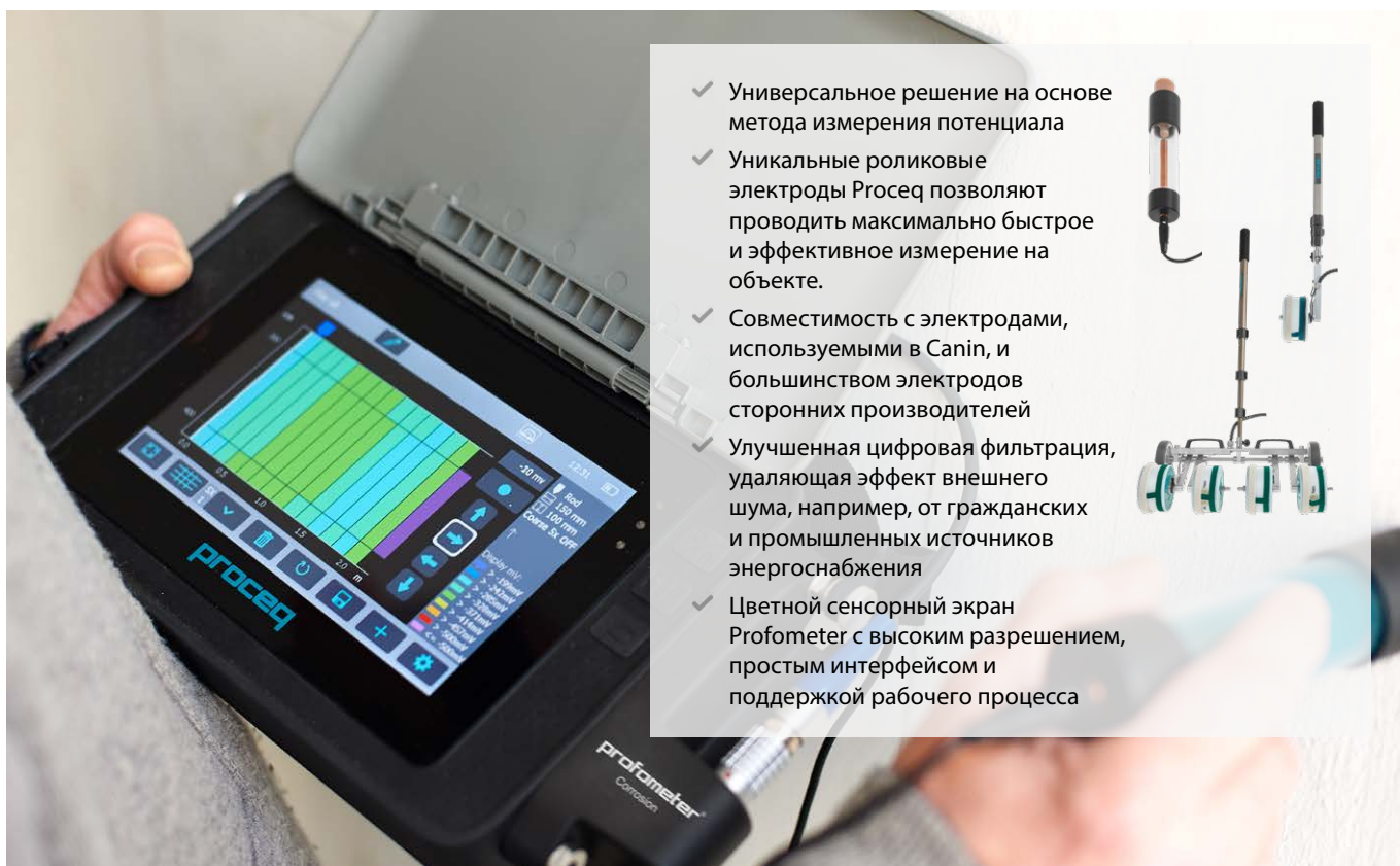
Электрод с четырьмя роликами Profometer Corrosion
