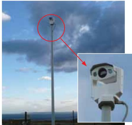
Установка FLIR Systems PTZ-35x140 MS. Она содержит две тепловизионные камеры и одну камеру дневного света, способную работать при низком уровне освещенности.
