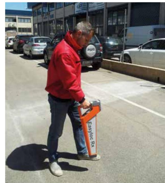
Easyloc является простой и быстрой в работе системой для обнаружения и определения местоположения подземных кабельных и трубопроводных систем. Приемник Easyloc показывает уровень принимаемого сигнала и помечает максимум. Операторы могут работать все время как с звуковой индикацией сигнала, так и с визуальным представлением. Измерение глубины осуществляется нажатием кнопки при нахождении над трассой коммуникации.
