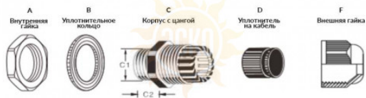
Схема кабельного ввода FGB
