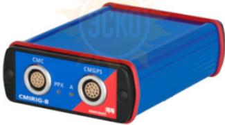
CMIRIG-B — это блок синхронизации, обеспечивающий возможность подсоединения устройств, передающих или получающих протокол IRIG-B или PPS сигналы с помощью испытательных комплектов CMC. CMGPS 588 дополнительно может использоваться как источник запускающего импульса синхронизации или сигнал PPS.
