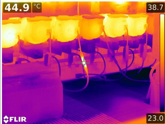
FLIR T1020 – Плохое электрическое соединение на двигателе
