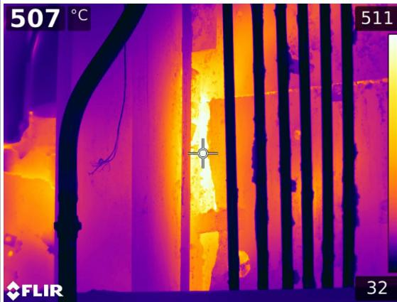
FLIR T1020 – Печь с плохой огнеупорной изоляцией
