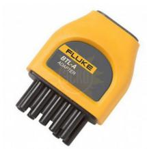
Адаптер Fluke BTL-A позволяет подключать стандартные тестовые разъемы 4 мм типа "банан" или токовые зажимы что дает возможность тестерам аккумуляторных батарей Fluke серии 500 проводить измерения переменного и постоянного напряжения, а также - тока с помощью токовых клещей Fluke i410. Адаптер Fluke BTL-A совместим с моделями Fluke BT510, BT520, BT521.
