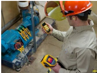
Рис. 2. Прием и сохранение в приложении Fluke Connect на смартфоне результатов измерений с приборов, подключенных к беспроводной сети
