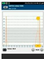
Высокочастотный анализ перекрестных наводок (HDTX) демонстрирует, что проблема заключается в соединении на дальнем конце
