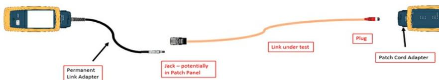
Адаптер коммутационных шнуров поддерживает уровни производительности категорий 5е, 6 и 6А и работает со всеми моделями анализаторов **DSX CableAnalyzer™**. Для использования тестировочных допусков MPTL необходима последняя версия микропрограммного обеспечения **Versiv/DSX**.
