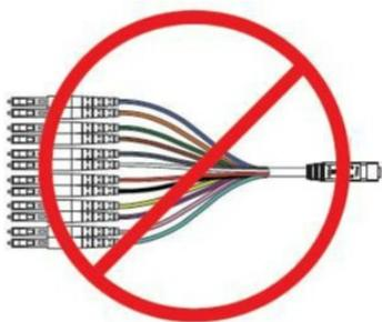
Незакрытые части подвергают кабели, оборудование и тестеры риску загрязнения и влияют на производительность. Обеспечение закрытого соединения защищает тестер от грязи и пыли. MultiFiber Pro позволяет легко закрыть разъем MPO, что повышает надежность тестирования.
