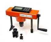
При проведении испытаний, связанных с обеспечением контроля за работами по применению анкерных креплений, крайне важно обеспечить высокую точность измерений и объективность получаемых данных. Среди обязательных для отслеживания параметров - усилие, требуемое для вырыва анкера, составного крепежного элемента, из основания материала, в котором он закреплен. Для замеров с необходимым уровнем точности получаемой информации оптимально использовать измеритель усилия вырыва фасадных анкеров ОНИКС-1.ВД.
