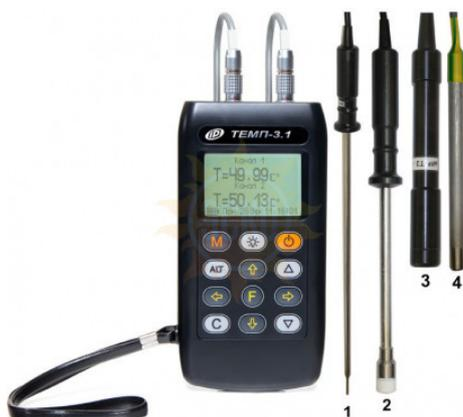
Термометры **ТЕМП-3.1** используют для одно- и двухканального контроля температуры различных жидких и газообразных сред, поверхностей, в том числе контроля монолитного бетона при выдерживании и электропрогреве.
