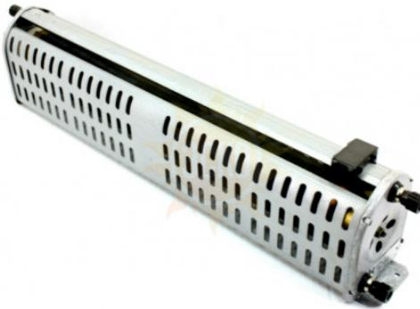
РСП-4-1 является ползунковым реостатом сопротивления, который позволяет плавно регулировать силу тока или напряжения в цепях постоянного и переменного тока. Используется в производственных и лабораторных условиях.
