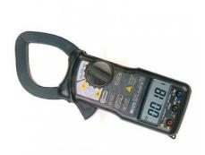
Диаметр **захвата** 55 мм Переменное напряжение 600 B Постоянное напряжение 600 B Переменный ток 0 - 2000 A Постоянный ток 0 - 2000 A Частота тока 0 Гц - 1 МГц Назначение Токовые клещи Измерение сопротивления Есть Измерение температуры Нет
