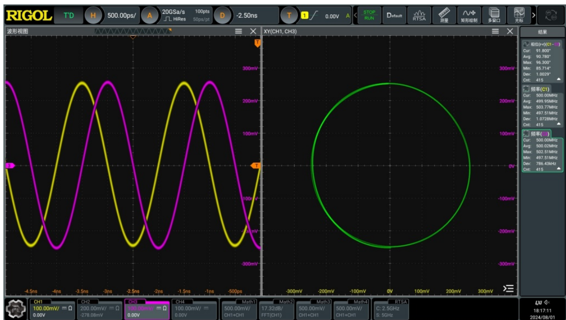
Высокая частота дискретизации 2,5 Гвыб/с, максимальная частота выходного сигнала 250 МГц с низким уровнем искажений
