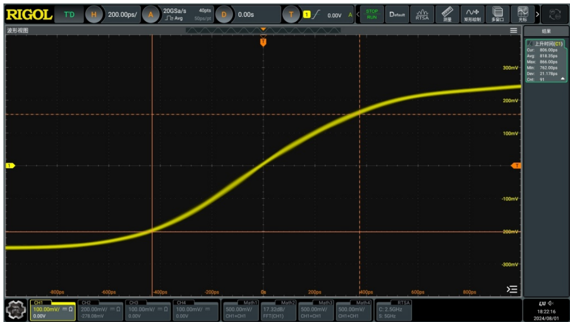
Прямоугольные сигналы с максимальной выходной частотой 170 МГц, длительность фронта/ время нарастания всего 0,8 нс (тип.)
