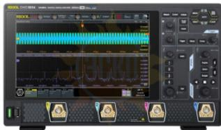
Цифровой осциллограф **RIGOL DHO5054** – 4-х канальный высокопроизводительный осциллограф высокого разрешения (12-бит) с полосой пропускания 500 МГц, выполненный в компактном корпусе, с возможностью работы от источника автономного питания. DHO5054 построен на технологической платформе «Centaurus», собственной разработки RIGOL.
