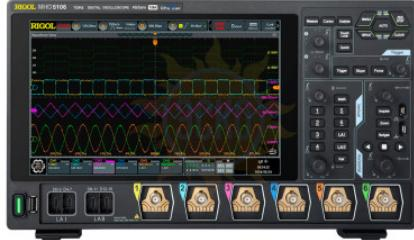
Цифровой осциллограф **RIGOL MHO5106** – 6-ти канальный высокопроизводительный осциллограф высокого разрешения (12-бит) с полосой пропускания 1 000 МГц, выполненный в компактном корпусе, с возможностью работы от источника автономного питания. MHO5106 построен на технологической платформе «Centaurus», собственной разработки RIGOL. Имеется встроенный генератор сигналов и опционально наличие цифровых каналов, используя пробник PLA3204.
