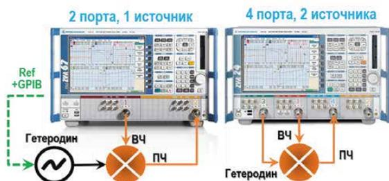
Целью измерений параметров гармоник является измерение параметров нелинейных искажений ИУ. Источник сигнала генерирует сигнал основной частоты, в то время как приемник настраивается на частоту n-кратную основной.
