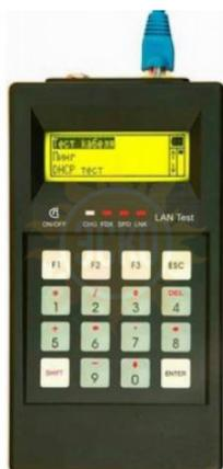
Универсальный тестер поиска неисправности в ЛВС **LAN Test** предназначен для проведения в полевых и стационарных условиях проверки состояния кабелей связи ЛВС, проверки соединения до указанного хоста посылкой ICMP пакетов, теста на работоспособность DHCP сервера, а также серверов, работающих по протоколу TCP.
