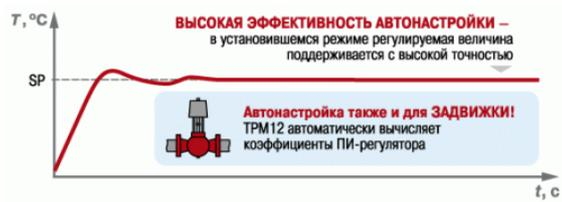
При автонастройке прибор вычисляет оптимальные для данного объекта значения коэффициентов ПИД-регулирования. Последующая несложная ручная подстройка позволяет свести к минимуму перерегулирование.
