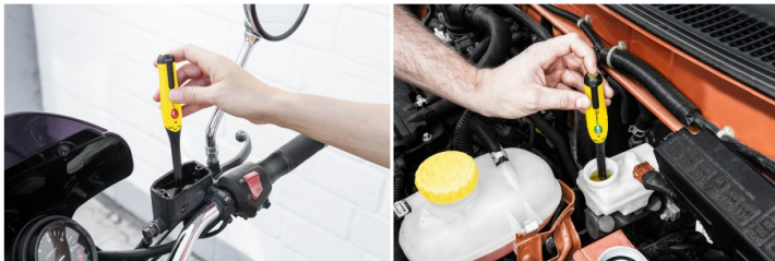
Красный светодиод указывает на то, что тормозную жидкость этого мотоцикла следует заменить как можно скорее. Зеленый цвет указывает, что тормозная жидкость в рабочем состоянии.
