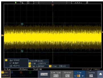
Типичный уровень пульсаций выходного напряжения в полосе до 20 МГц не превышает 10 мВпик-пик
