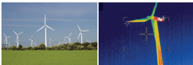
ИК-изображение ветровой турбины, полученное с земли
