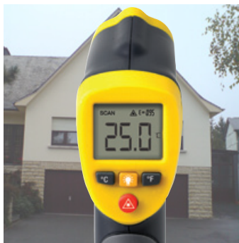
ИК-термометр, измерение температуры в одной точке
