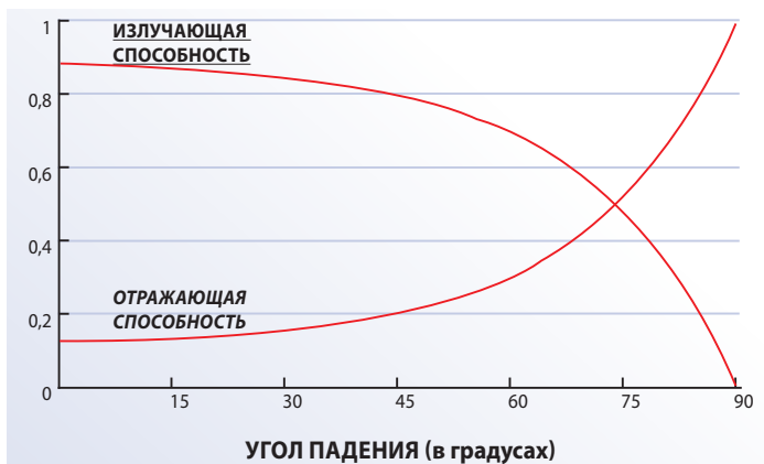
Угловая зависимость излучающей способности стекла
