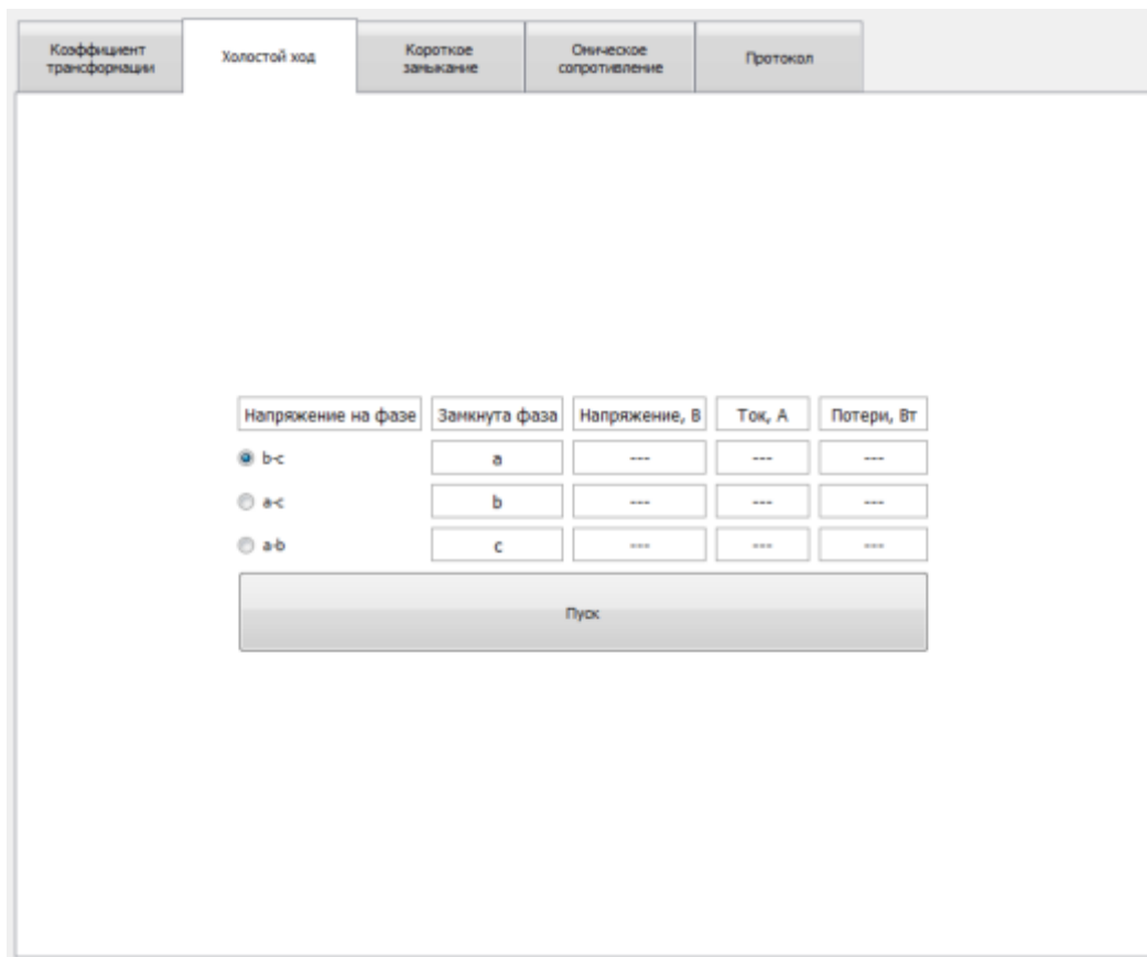
Рис. 17. Вкладка «Холостой ход» для испытания при малом напряжении
