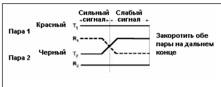
Рисунок 5. Подключите зажим красного цвета к исправной жиле пары 1. Подключите зажим черного цвета к разбитой жиле пары 2.
