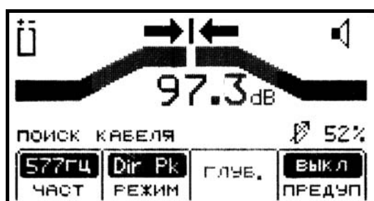
Приемник находится непосредственно над отыскиваемой трассой
